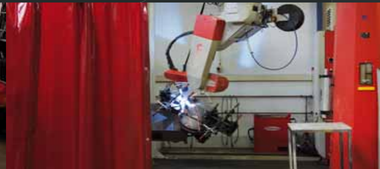
CNC-Schweißen CNC welding
